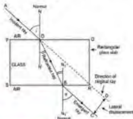
चित्र 10.9 काँचको स्लाबबाट प्रकाशको आवर्तन
