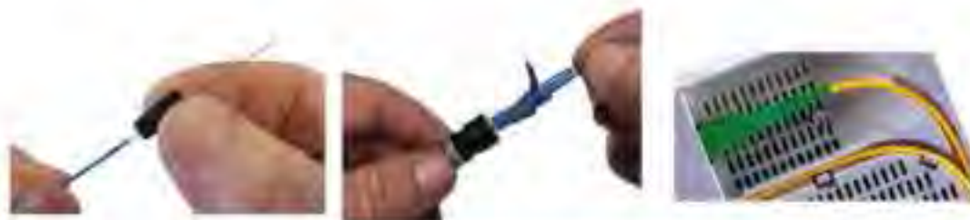
चित्र 10.32 राउटरमा अप्टिकल फाइबर कनेक्टरको जडान
