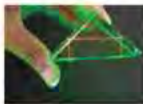
चित्र 10.24 समकोण त्रिभुजाकार प्रिज्ममा हुने पूर्ण आन्तरिक परावर्तन
